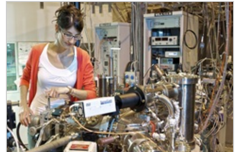
Die Doktorandin Elena Mengotti an der Mikroskopie-Strahllinie an der Synchrotron Lichtquelle Schweiz SLS. Hier kann die Magnetisierungsrichtung von Nanomagneten sichtbar gemacht werden.
